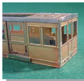
Darauf achten, dass Stirnwand 4 am Führerstandsende des TW eingelötet wird. (Erkennlich an der angegebenen Fahrshalterabdeckung). BW hat 2 gleiche Stirnwände 5
