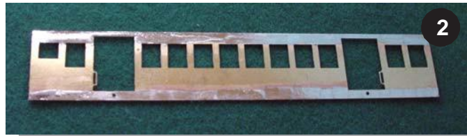
Seitenwände 2 und 3 auf der Rückseite verzinnen.
