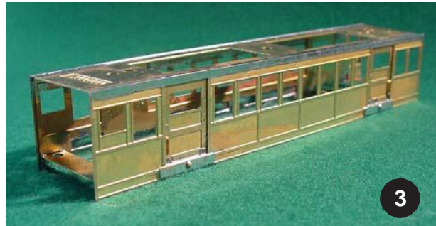
Seitenwände auf den Wagenkasten auflöten. Teile 7 im Bereich unterhalb der Türen auflöten. Niet 1 mm dient zur Ausrichtung.
